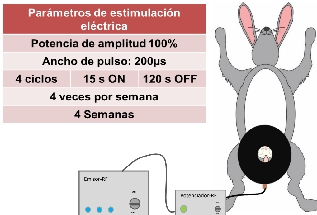
Figura 3. Configuración del equipo de estimulación inalámbrica del NeuroClip. A través de una laptop se establecieron los parámetros de estimulación en la interfaz gráfica del emisor de radiofrecuencia que genera las ondas RF que son incrementadas luego por el potenciador RF para ser emitidas finalmente en la antena colocada justo sobre el sitio del implante.
