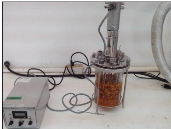
Figura 9. Biorreactor Applikon AD1 1012 con Motor Controller, Fermentación medio natural por 72 horas.
