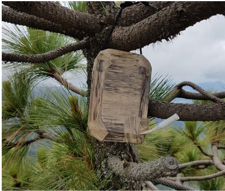
Figura 7. Dataloggers HOBO con cubierta y ubicado en una copa de Pinus hartwegii .
