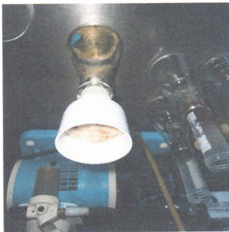
Fig. 10 Obtención del EBE por filtración y retención de la biomasa.
