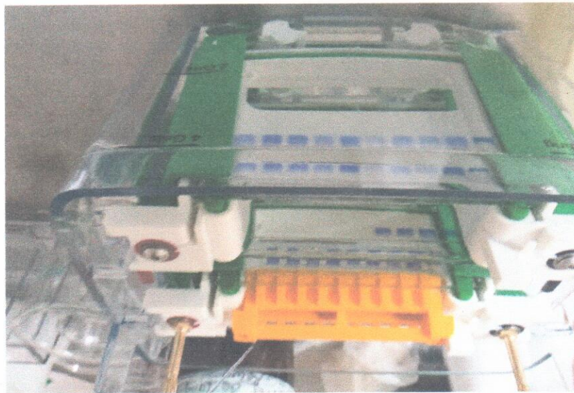
Fig. 15 Muestras cargadas en gels de poliacrilamida en un sistema de electroforesis Mini Protean Tetra Cell (Bio-Rad).
