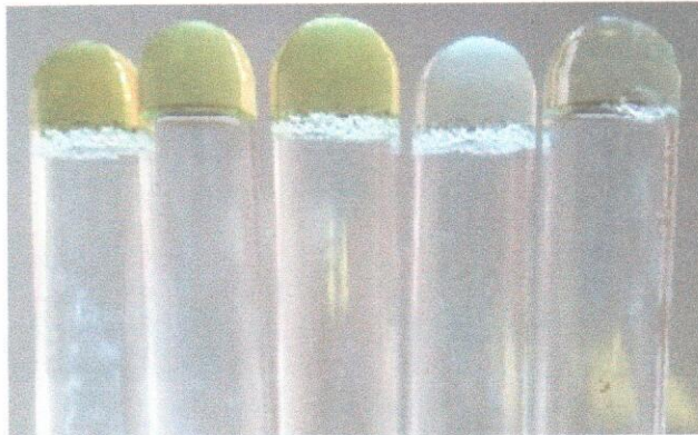
Fig. 12 Tubos de ensayo con la mezcla de reacción para determinar actividad de esterasas cutinoliticas
