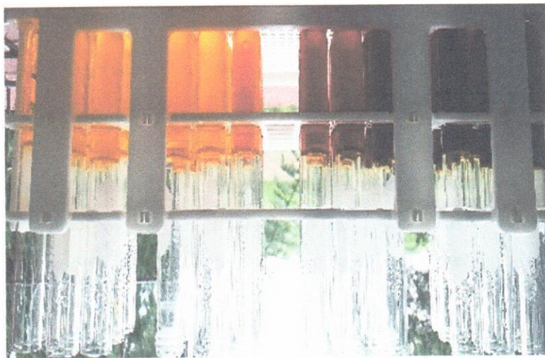
Fig. 13 Tubos de ensayo con la mezcla de reacción para determinar el contenido de glucosa del EEE por el método de DNS.
