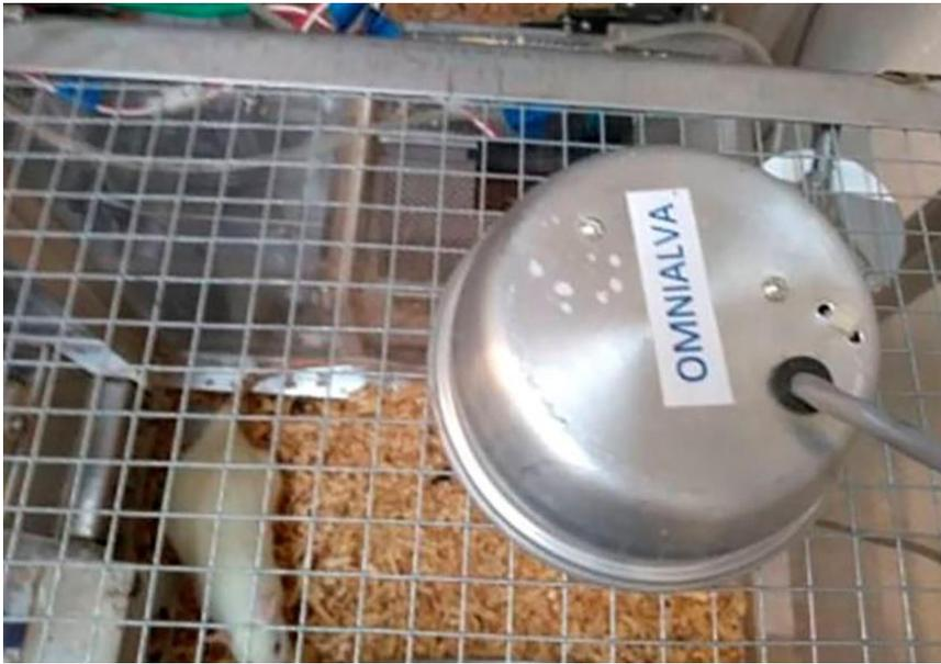
Figura 3. Sensores de registro de actividad locomotora colocados en la parte superior de la caja hospedera.
