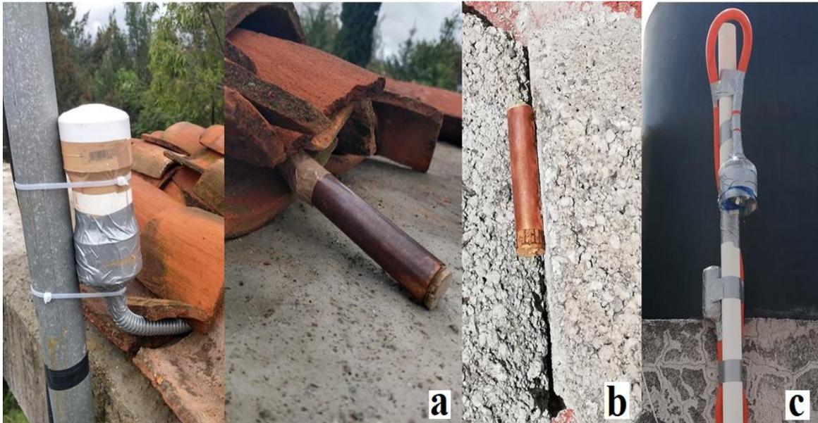
Figura 4. Modelos biofísicos de *Sceloporus spinosus* colocado en sitios de percha conectado a HOBOTemp pro v2-U23-003 (a). Modelos biofísicos con registrador de datos IBUTTON DS1921G-F5 en su interior (b). HOBOTemp pro v2-U23-002 para registrar temperatura ambiental (c).
