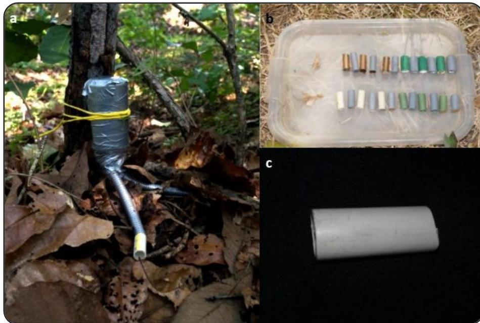
**Figura 10.** Registrador automático de datos (HOBO pro v2-U23-003) (a) conectado a los modelos biofísicos de PVC blanco rellenos de silicón de 4 cm(c) previamente calibrados (b)
