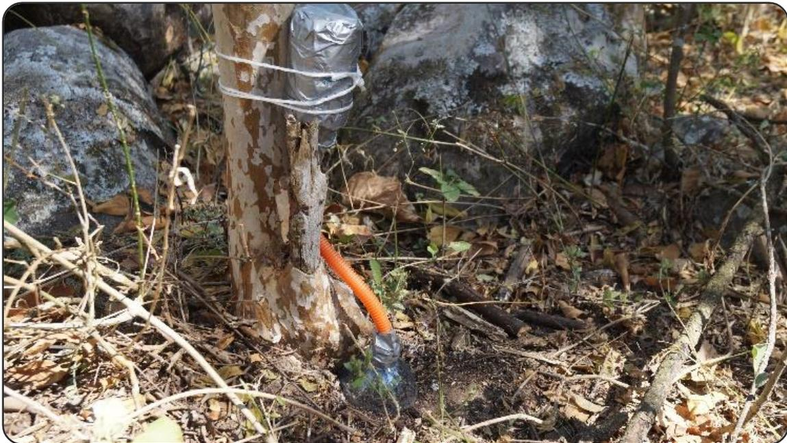
**Figura 8.** Registrador automático de datos (HOBO pro v2-U23-002) colocado en el sitio de percha de las lagartijas para registrar la temperatura ambiental y la humedad relativa.
