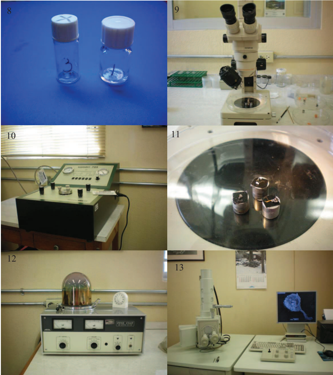
Figs. 8-13 Metodología para preparación de muestras para observación en microscopía electrónica de barrido (MEB). 8. Esporocarpos fijados en FAA. 9. Colocación de las muestras en los micro-barriles. 10. Secadora Sandri 795 para secado a punto crítico. 11. Montaje de los esporocarpos en el porta-muestras. 12. Ionizadora Geoli para metalizar las muestras con oro. 13. Observación en el microscopio electrónico de barrido.
